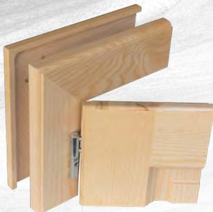
La face et la contre-face du chambranle sont en bois massif de largeur 80 mm en standard (possibilité de réduire les faces jusqu'à 40 mm ou de les augmenter jusqu'à 160 mm). L'ébrasement est fabriqué selon l'épaisseur du mur.
